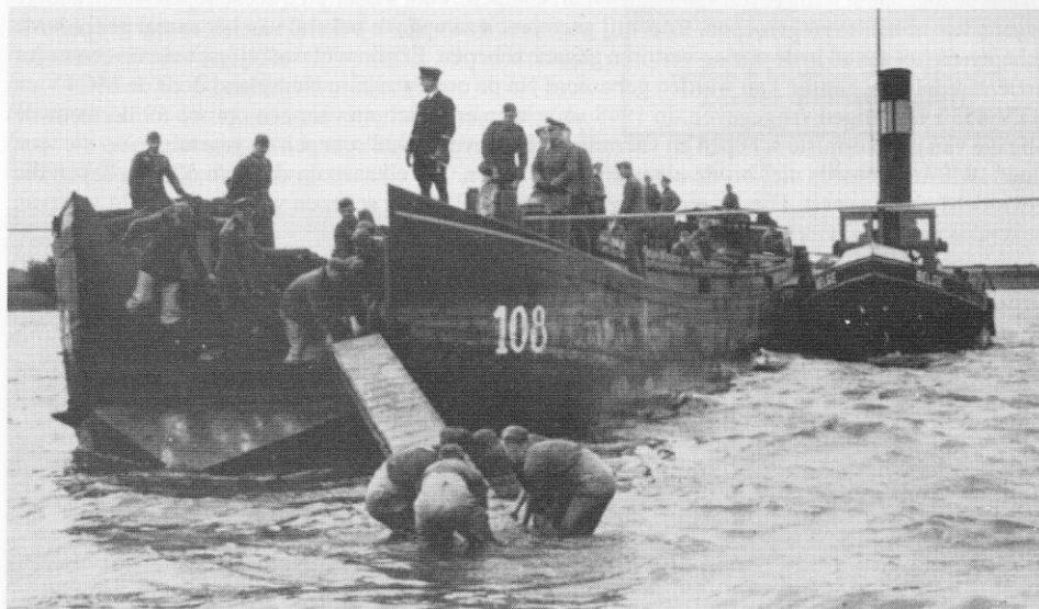
Een gekopt schip in actie tijdens een militaire oefening. De bedoeling was om aan land te gaan bij afnemend tij, als de afritten veilig konden worden uitgezet als het schip eenmaal aan de grond was gezet. Tijdens de feitelijke landingen moest het schip wachten tot het weer vloed was voordat zij weer vlot kon komen.
